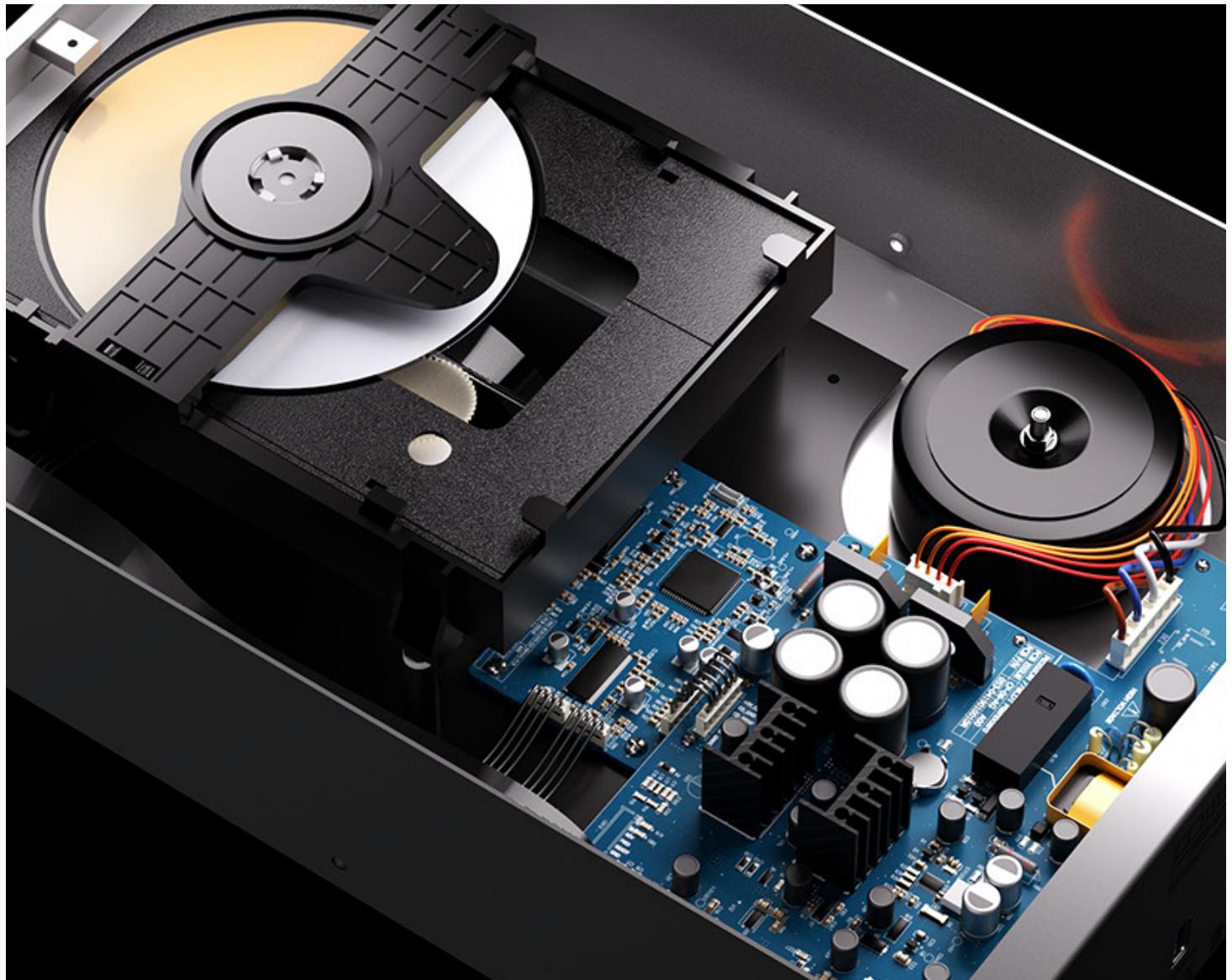
В соответствии с идеями Mission, конструкция устройства позволяет избежать ненужной сложности. Архитектура CD сервопривода намеренно упрощена, благодаря специальным малошумящим источникам питания, изолирующими взаимное влияние ключевых функций — транспорта, лазера, декодера и задающего тактового генератора. Предотвращая перекрестные помехи на схемном уровне, 778CDT гарантирует, что выходной сигнал остается чистым, стабильным и соответствующим источнику.
